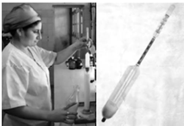
Ilustración 10: El lactodensímetro es una herramienta de uso práctico y eficiente en el sector.
